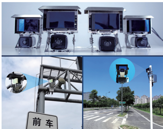
图 5. 镭神® 雷视一体机（激光雷达与摄像头）及实际部署场景
