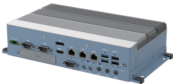
图 3. 集和诚® 路侧 MEC 设备 ( KMDA-3301 型 )
